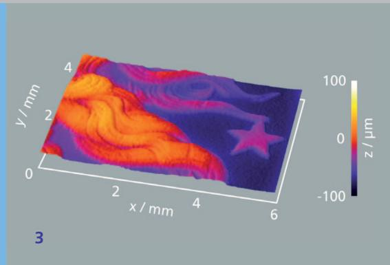
1 *HoloTop* vermisst die Topographie von Oberflächen so rasch und zuverlässig, dass es in der Inline-Kontrolle eingesetzt werden kann.
